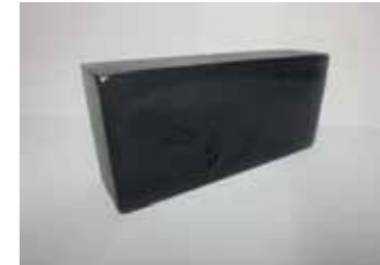
(ii)cブラウン管を再利用したブロック
